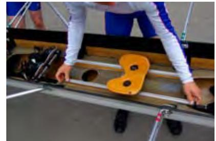
Die Rollschienen auf die richtige Länge schieben und die Flügelmuttern wieder anziehen - ABER immer bedenken, dass „nach fest kommt ab“! Auf dem Wasser kann man die Rollschienen nur sehr schwer einstellen.
